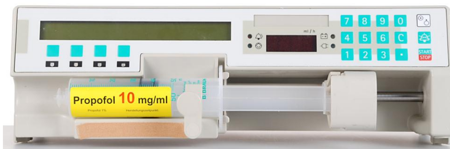
Abb. 5: Blick auf eine Spritzenpumpe bei korrekt platziertem Etikett.
